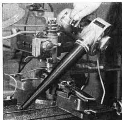
Son jet dense d'air comprimé (180 cm<sup>3</sup>/heure) et son bec flexible en caoutchouc permettent d'enlever les encrassements les plus épais et de pénétrer dans toutes les parties des machines même les plus difficilement accessibles.
